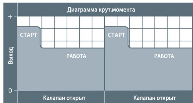
\*Все гидравлические или пневматические привода для дроссельных заслонок поставляются без бегунка индикации или механизма twin power. Тем не менее, они обеспечивают постоянный крутящий момент вместо двухступенчатого, как при использовании стандартного пневматического устройства.
