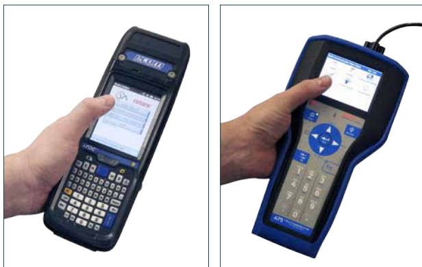
Рисунок 1. Слева: ECOM, Справа: Rosemount 475. Привод CVA возможно настроить устройством с Bluetooth таким как ПК или стандартным HART коммуникатором, таким как ECOM или Rosemount 475
