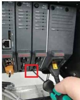
4. Tirare la linguetta verso l'esterno della *Master Station* per estrarre il modulo. E' importante estrarre il modulo con movimento dolce e lineare per evitare torsioni e danneggiamenti ai componenti.
