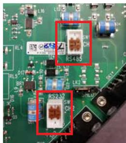
6. Dopo aver completato le impostazioni di entrambi i micro interruttori per il tipo di comunicazione corretta reinserire il modulo effettuando le operazioni di smontaggio in senso inverso. ogni feritori per AIM include guide in plastica per assicurare che le schede PCB siano allineate correttamente con la *Master Station*. Controllare che la parte superiore ed inferiore della scheda siano inserite nelle guide patiche prima di completare l'inserimento del modulo AIM nella *Master Station*.
