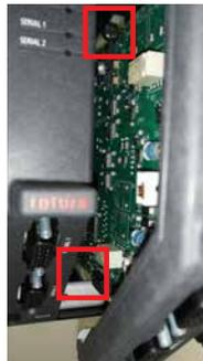
7. Avvitare le viti di fissaggio e riaccendere la *Master Station*. Dopo qualche minuto controllare che il modulo seriale AIM stia comunicando con la *Master Station*.
