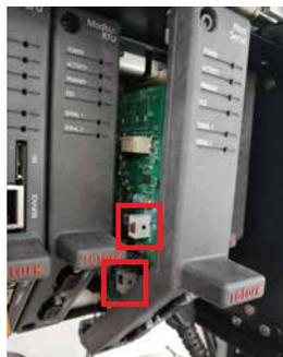
5. Impostare i micro interruttori DIP nella posizione desiderata per ogni porta seriale. SW1 (CH1) determina l'impostazione per Seriale 1. SW2(CH2) determina l'impostazione per Seriale 2. Muovere verso l'alto per impostare RS-232 o verso il basso per RS-485.
