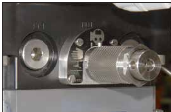
Рис. 6.1.1. Рукоятка включения ручного дублёра
