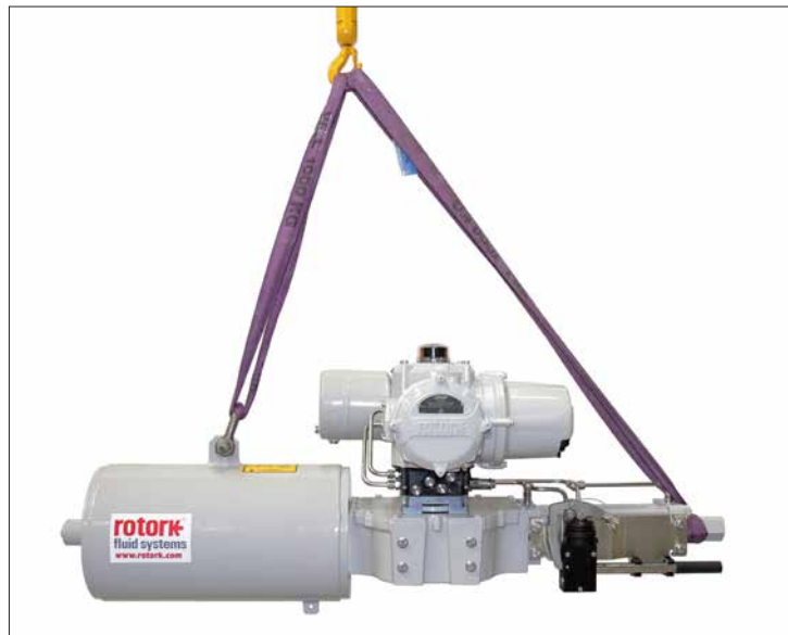
Рис. 4.1.1. Подъем SI3: Стропы закреплены за проушину и крышку стопорного болта гидравлического цилиндра.
