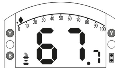
図 4.4.4 Torque(A)+Position
