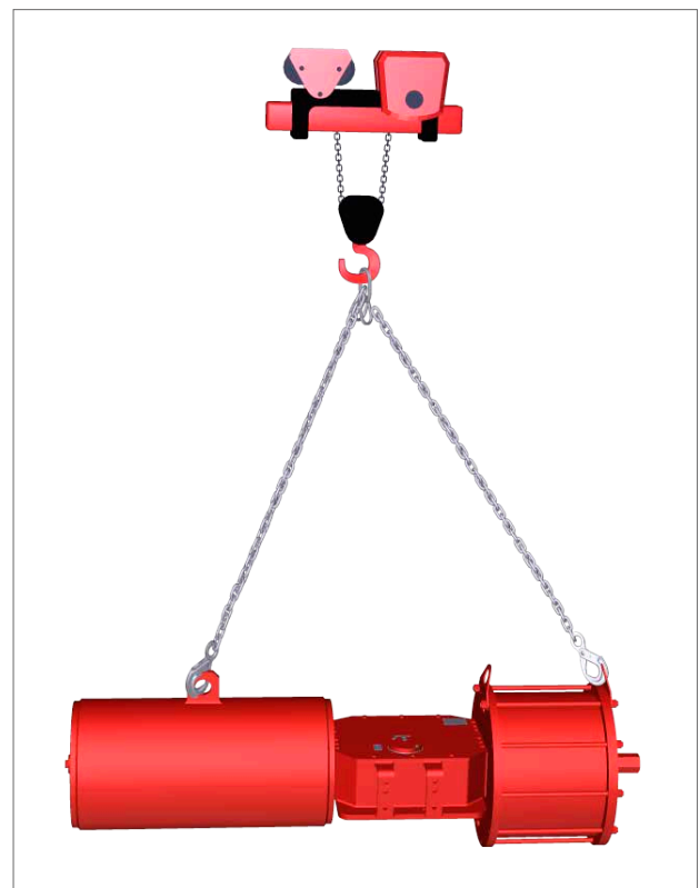
Fig 7.1 Elevación (actuador de efecto simple hasta tamaño 161)
