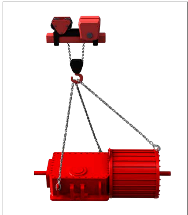
Fig 7.4 Elevación (actuador de efecto doble tamaño 200 - 350)
