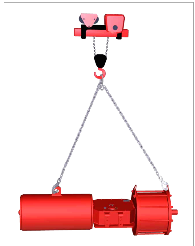
图 7.1 吊装(最大尺寸为161的单作用执行器)
