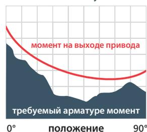
Четвертьоборотные пневматические приводы серии GP
