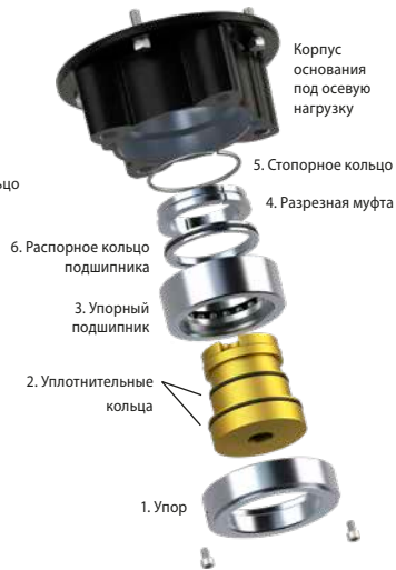
Рис. 5.1.3 Основание в сборе F14 и F16
