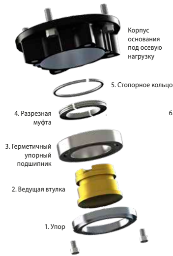
Рис. 5.1.2 Основание в сборе F10
