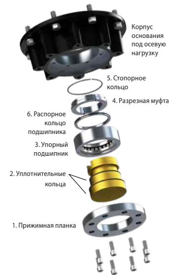
Рис. 5.1.4 Основание в сборе F25 и F30
