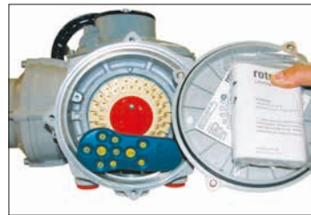
Рис. 7.3.2 Клеммный блок привода и пульт настройки (Упаковывается отдельно в упаковочной коробке).
