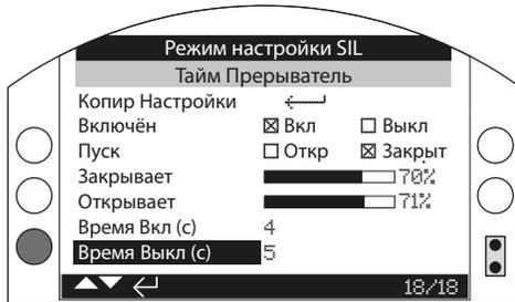
**Копир Настройки** – Использовать эту функцию для копирования параметров стандартного ТП. Использовать это только в том случае, если во время хода SIL ПАЗ требуются такие же параметры ТП. Используя кнопки со стрелками и , выбрать Копир Настройки и нажать кнопку . После выполнения, следовать инструкциям по настройке параметров и активации SIL в разделе 5.3.
