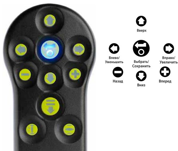
Защищённое по умолчанию от несанкционированного доступа Bluetooth подключение включается по инфракрасному порту. Для этого требуется, чтобы пользователь находился на расстоянии не более 0.25 м от привода и в прямой видимости дисплея.
