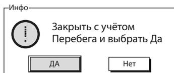
Переместить привод и арматуру в закрытое положение. Принять в расчёт перебег и вращать в сторону открытия 1/2 до 1 оборота штурвала.
