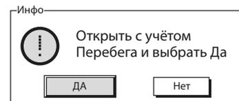
Переместить привод и арматуру в открытое положение. Принять в расчёт перебег и вращать в сторону закрытия 1/2 до 1 оборота штурвала.
