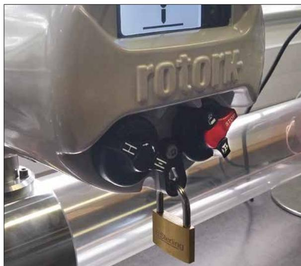
Рис. 7.2. Селектор управления IQ заперт на висячий замок в "Дистанционное"
