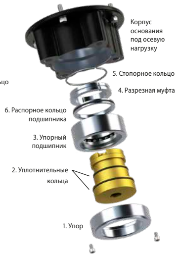
Рис. 5.1.3 Основание в сборе F14 и F16
