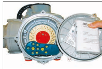
Рис. 7.3.2 Клеммный блок привода и пульт настройки (Упаковывается отдельно в упаковочной коробке).
