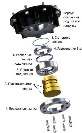
Рис. 5.1.4 Основание в сборе F25 и F30
