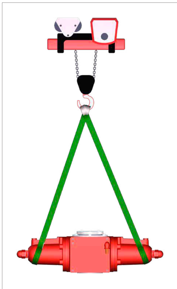
Рис. 7.2 Подъём RH двустороннего действия размеры корпуса 015, 030, 060, 120, 240.
