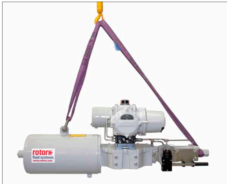
Fig. 4.1.1. Heben des SI3: Die Seile sind an der Hebeöse und der Abdeckung des Anschlagbolzens des Hydraulikzylinders angeschlagen.
