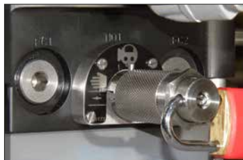
Abb. 6.1.2. Mit einem Vorhängeschloss blockierter Griff
