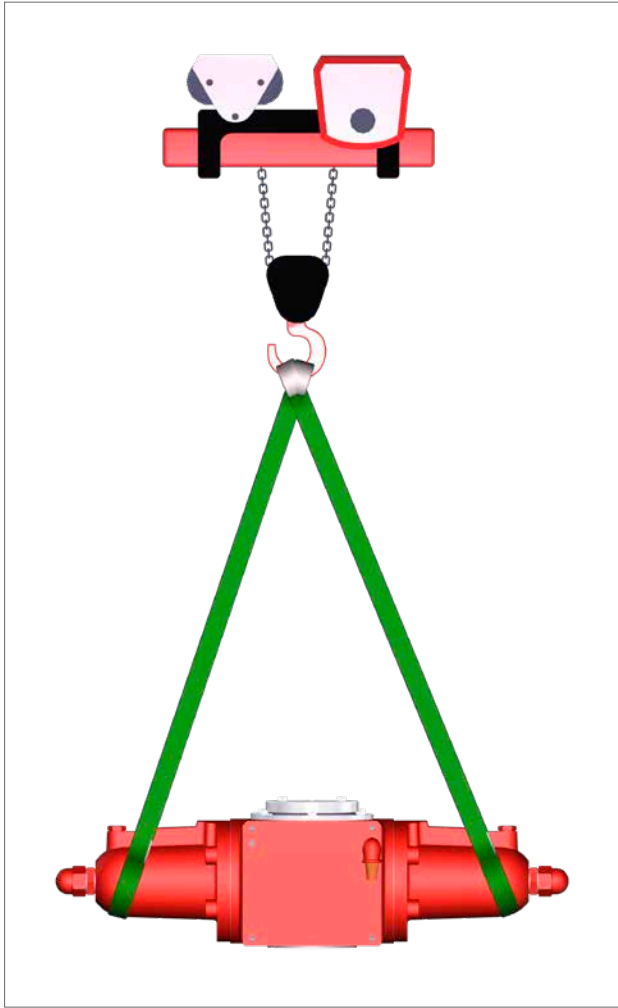
图 7.2 RH系列双作用执行机构 (中心体尺寸: 015、030、060、120、240) 的吊装
