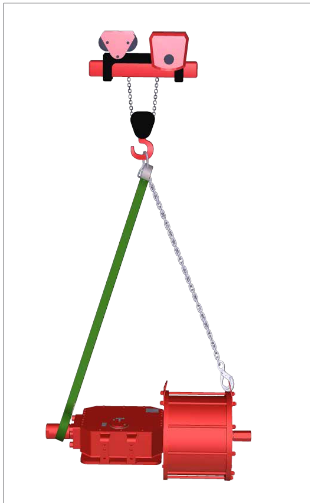
Abb. 7.2 Anheben (doppelt wirkender Stellantrieb bis Größe 161)
