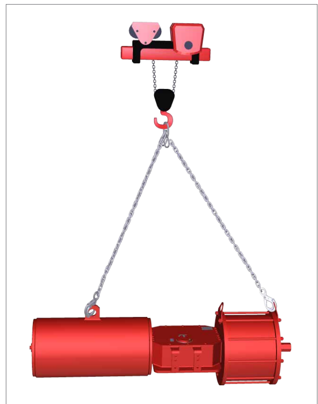
Abb. 7.1 Anheben (einfach wirkender Stellantrieb bis Größe 161)
