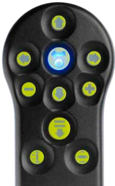
Unten finden Sie die relevanten Navigations- und Konfigurationstasten zur Inbetriebnahme eines IQT-Antriebs.
