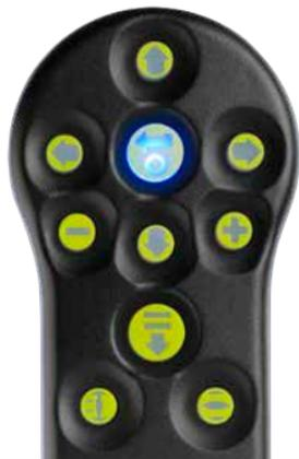
Qui sotto sono raffigurati i pulsanti di navigazione e configurazione per effettuare il commissioning di un attuatore IQT.
