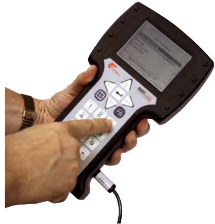
图1. Rosemount 375. CVA可以通过运用PDA或者PC等蓝牙装置, 或者用HART通讯装置代替。
