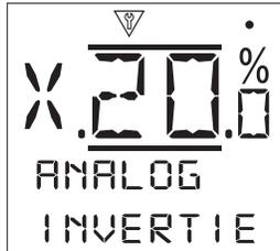
**Invertieren [INVERTIE]:** - Wählen Sie aus, ob das 4 mA-20mA Ausgangssignal ansteigt oder fällt, wenn die Armatur öffnet. ⚙️ ⬆️ ⬇️ ⚙️
