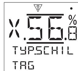
**Tag-Nummer [TAG]:** - Die TAG-Nummer wird auf dem Startbildschirm des Stellantriebs angezeigt. Die Tag-Nummer sollte die Referenznummer sein, die dieses Anlagenteil im Prozessschema hat. Wenn die Tag-Nummer bei der Bestellung angegeben wurde, führt Rotork diese Eingabe automatisch aus.
