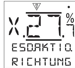
**Laufrichtung [RICHTUNG]:** - Stellt die gewünschte Reaktion auf einen Notfahrbefehl ein.
