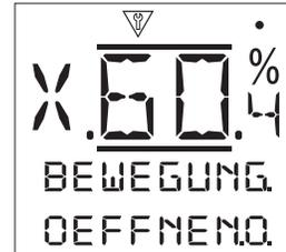
**Öffnen [ÖFFNEN]:** - Zeigt den Status für Fahren in Aufrichtung an. Falls aktiv, dann fährt die Armatur gerade auf.
