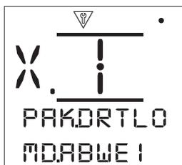
**Drehmoment aktualisieren [MD.ABWEI.]:** - Der Wert entspricht der Änderung des Drehmoments, die eintreten muss, bevor Drehmomente an die Master Station gemeldet werden. Während des Verfahrens wird jedes Mal ein neuer Wert gemeldet, wenn die Änderung die eingestellte Abweichung überschreitet. Wird diese Funktion nicht benötigt, dann soll die Funktion ausgeschaltet werden. Bereich 0% (deaktiviert) bis 20%. ⏪ ⏩ ⏴ ⏵
