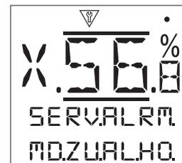
**Hi Alarm schließen % [MD.ZU.AL.HO.]:** - Erlaubt die Einstellung eines Wertes für Alarmmeldung schließen Z. B. 70%.
