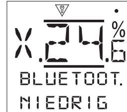
**Niedrig: Immer [NIEDRIG]** – Der Antrieb ist zu jeder Zeit für *Bluetooth* Kommunikation mittels PC und laufender Insight2 Software verfügbar. Diese Einstellung ist beim Gebrauch von Insight2 komfortabel. Kommunikation mit dem *Bluetooth* Einstellgerät ist verfügbar.
