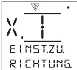
**Schließrichtung [RICHTUNG]:** - Geben Sie die Laufrichtung zum Schließen der Armatur ein, Rechts- oder linksdrehend bei Blick von oben auf den Antrieb .
