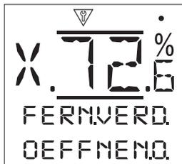
**Öffnen [OEFFNEN]:** - Zeigt den aktuellen Status für Fernsteuerung „Öffnen“ an. Wenn Kontrollkästchen aktiv, dann wurde ein Fahrbehl für Öffnen über Steuerkabel ausgelöst und von der Steuerung empfangen.
