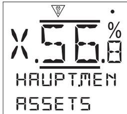
Verfahrenstechnik und kann verwendet werden, um die Verfügbarkeit der Armaturen zu erhöhen und Wartungspläne zu erstellen. Informationen bezüglich Prozesses, Armatur und Antrieb können im Centronik-Steuermodul gespeichert werden. Außerdem können die Installations- und Inbetriebnahme, sowie der Serviceverlauf des Antriebs aufgezeichnet werden. Asset Management Alarme können eingestellt werden, um mögliche erforderliche Wartungsarbeiten anzudeuten.
