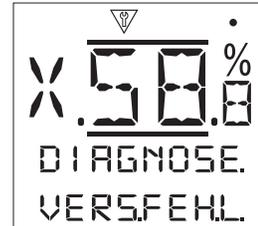
**Versorgung ausgefallen [VERS.FEH.]:** - Zeigt den Status der Spannungsversorgung an. Wenn aktiv, liegt ein Ausfall einer oder mehrerer Phasen vor. Ist die Anzeige am Antrieb beleuchtet, liegt wahrscheinlich ein Ausfall der 3. Phase vor. Überprüfen Sie alle 3 Phasen.
