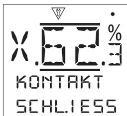
**S Kontaktart [KONTAKT]:** - Jeder Meldekontakt kann als Öffner (wenn Bedingung erfüllt) oder Schließer (wenn Bedingung erfüllt) konfiguriert werden.
