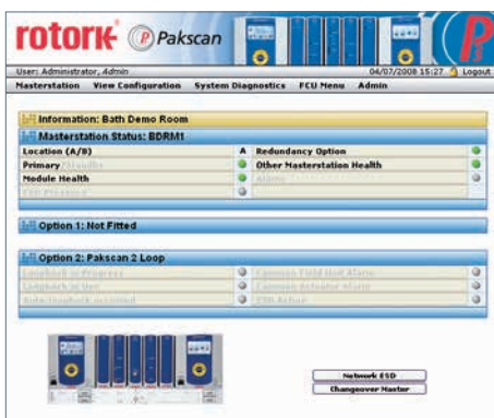
Fig. 19. Tela de abertura do navegador da Web
