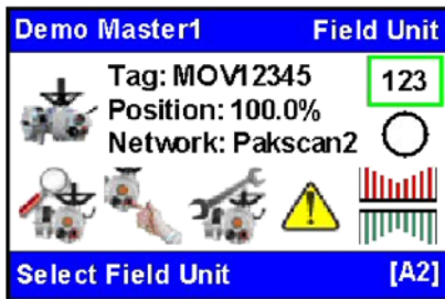
Fig. 15. HMI – controle e monitoramento de MOV
