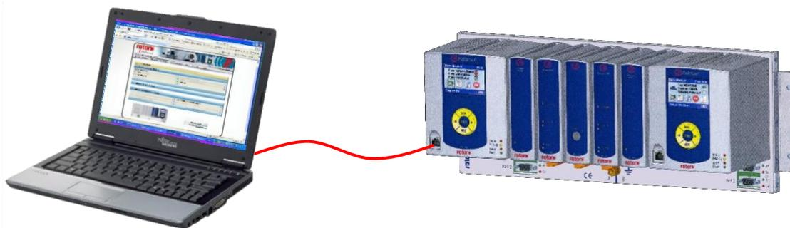
Fig 33: Conectando um laptop ao módulo principal Pakscan P3
