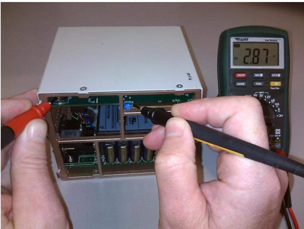
A bateria deve durar aproximadamente dois anos e ser substituída após esse tempo como rotina. Ela também deverá ser substituída se a tensão medida for inferior a 2,7 volts.
