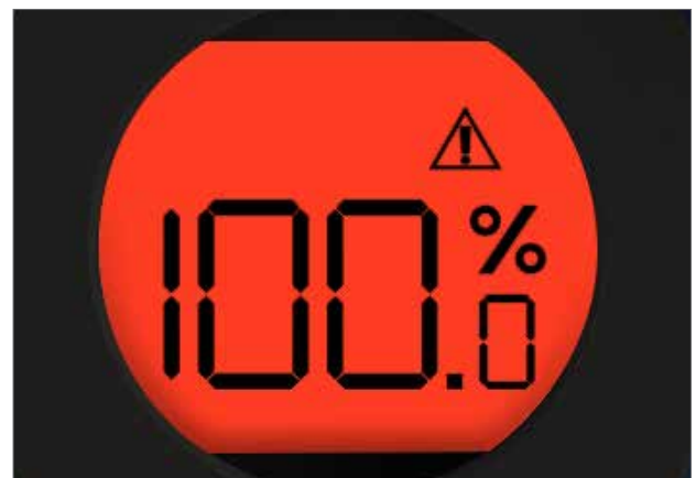
図 5.7 電源の故障時には、アクチュエータは赤・白交互に点滅します
