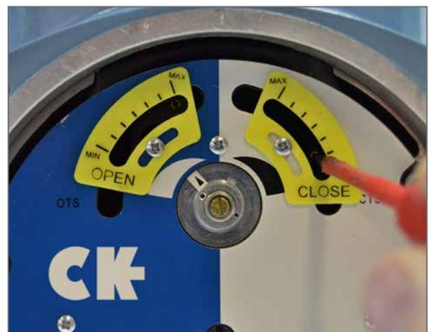
**⚠ VORSICHT:** Der Schraubendreher muss bei der Einstellung der Grenzwerte der Drehmomentabschaltung senkrecht zur Frontplatte des Schaltmechanismus gehalten werden, um einen Versatz des eingestellten Werts zu vermeiden.
