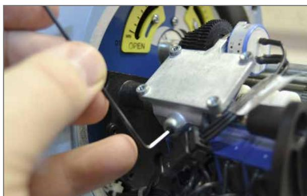
**⚠ CUIDADO: A definição de limites no módulo de controle do Centronik é necessária para escalonar automaticamente os valores do POT de 0 a 100%.**
