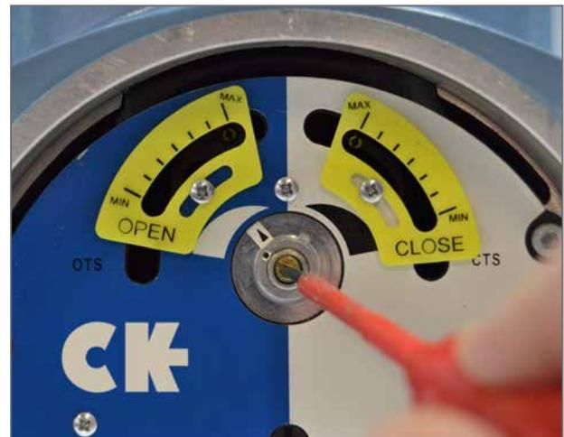
2) Ajuste cada came de torque de acordo com o valor desejado (entre mín. e máx.) movendo o came com o uso de uma chave de fenda no ponto de ajuste.
