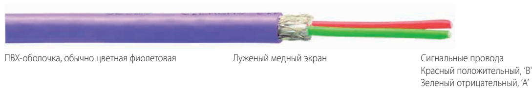
Рис 17: Спецификация кабеля Profibus DP
