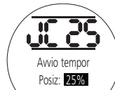
Temporizzatore impostato in modo da avviarsi quando la valvola in chiusura raggiunge il 25% di apertura
