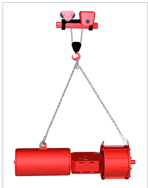
Afb 7.1 Optillen (enkelwerkende aandrijving tot maat 161)
