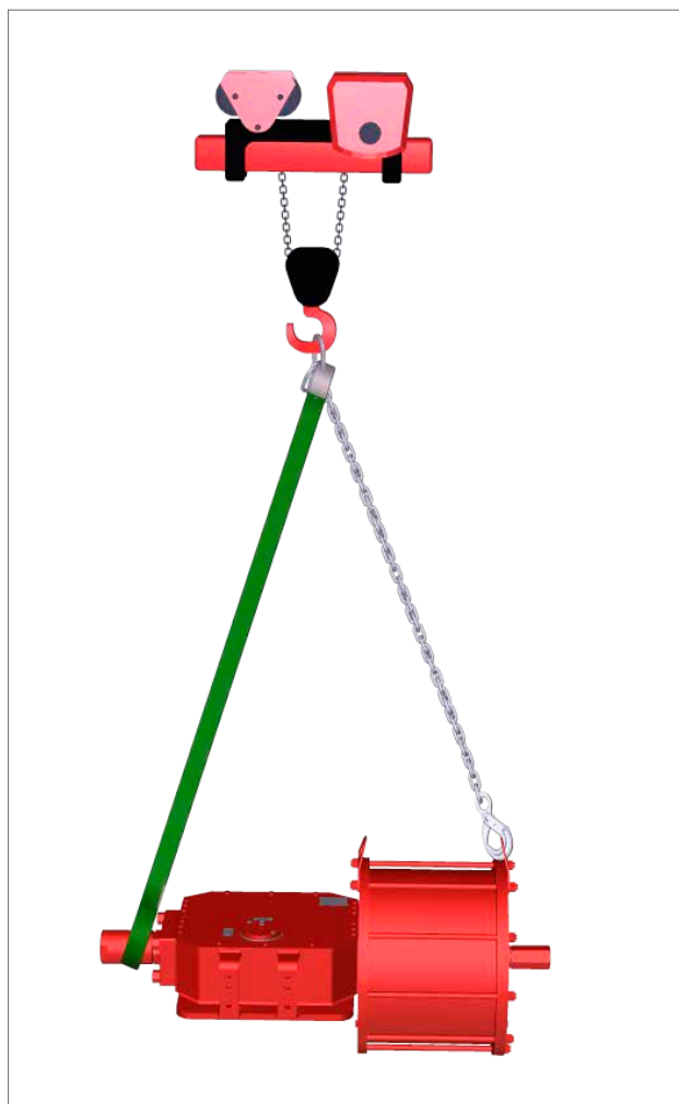
Afb 7.2 Optillen (dubbelwerkende aandrijving tot maat 161)
