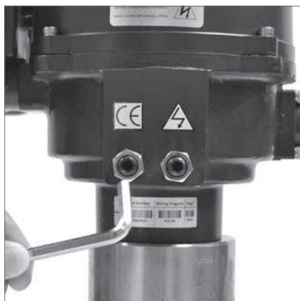
左回転閉止の場合の閉側ストップボルト
