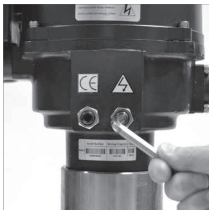
右回転閉止の場合の閉側ストップボルト
