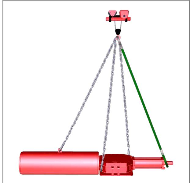
图 7.3 吊装 (尺寸为 200-350 的单作用执行器)
