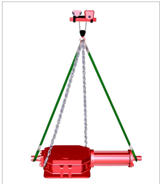
图 7.4 吊装 (尺寸为 200-350 的双作用执行器)
