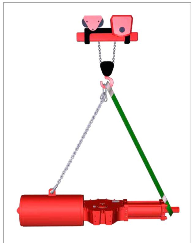
图 7.1 吊装（最大尺寸为 161 的单作用执行器）
