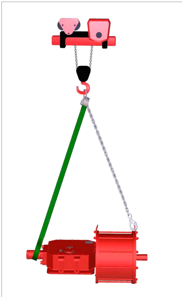
Fig 7.2 Løft (dobbelvirkende aktuator op til størrelse 161)
