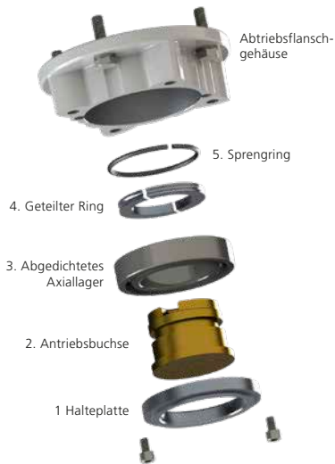
Abb. 5.1.2 F10-Abtriebsflansch-Baugruppe
