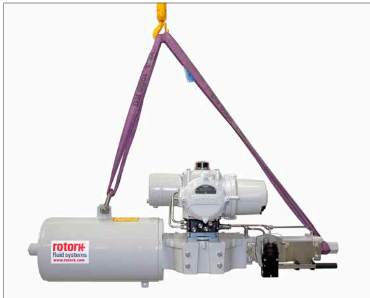
图 4.1.1 SI3吊装：吊索连接到吊眼和液压缸止位螺栓盖上。
