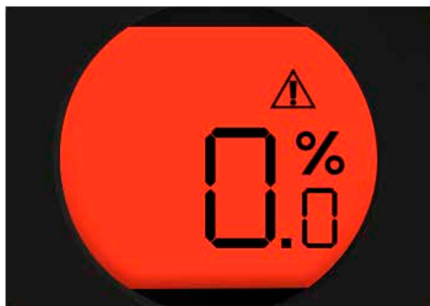
Rys. 9.3 Wyświetlacz siłownika miga na czerwono i biało, gdy bateria super kondensatorów jest aktywna podczas awarii zasilania.
