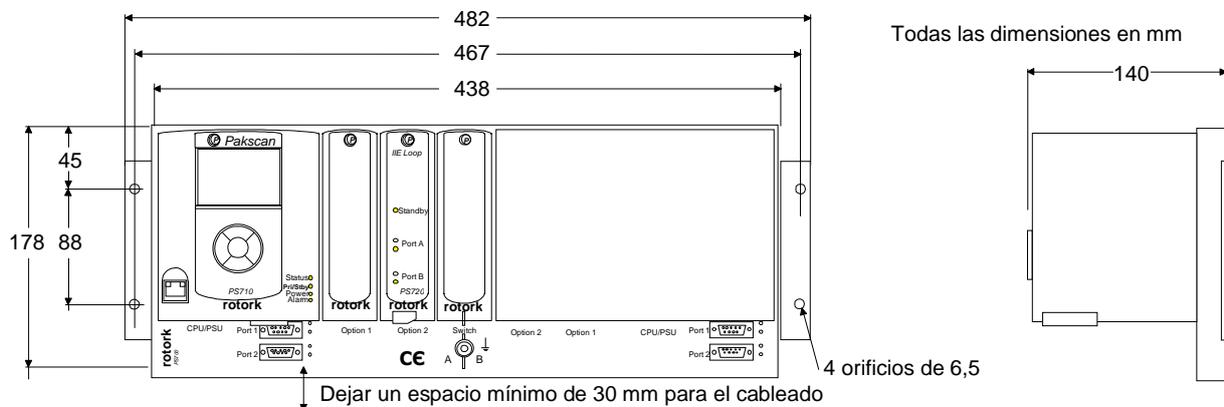
**Fig. 6: Dimensiones del montaje en superficie del Pakscan 3**
