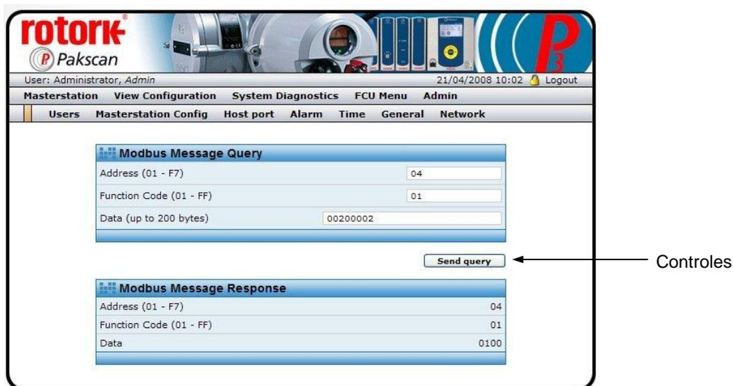
Fig. 77: Página web del Generador de mensajes de Modbus
