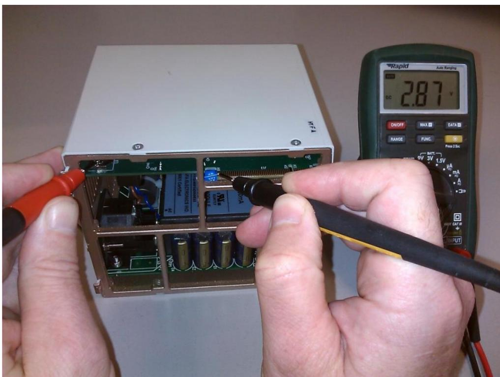
La pila debería durar unos dos años y debería reemplazarse después de este tiempo. También debe reemplazarse si el voltaje medido es inferior a 2,7 voltios.
