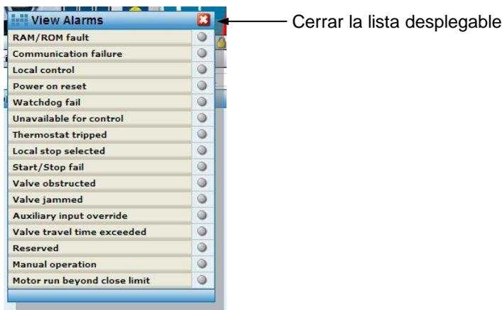
Fig. 52: Ventana desplegable Alarmas IQ/IQT cableados
