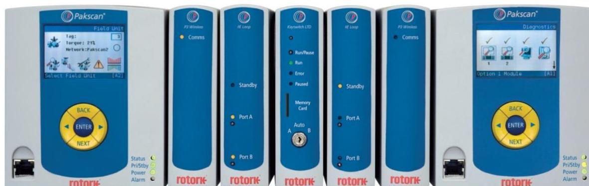
Fig. 84: Estación maestra de reserva en caliente con registrador de datos a largo plazo (LTD)
