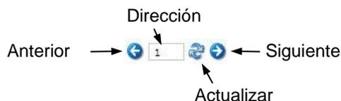
La navegación entre las unidades de campo se realiza volviendo a la pantalla anterior o usando los botones de navegación de esta pantalla. Introduciendo una dirección directamente en la casilla 'Address' y haciendo clic en 'Actualizar' se pasa directamente a la unidad de campo seleccionada.
