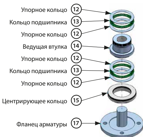
Рисунок 12 – Установка на шток арматуры
