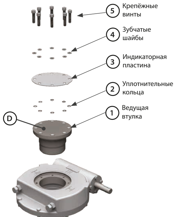
Рисунок 1 – Расположение ведущей втулки
