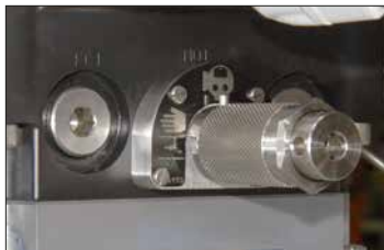
Fig. 6.1.1. Manivela de controle manual do SI
