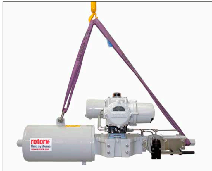
Fig. 4.1.1. Içamento do SI3: Eslingas presas ao olhal de içamento e à tampa do parafuso batente do cilindro hidráulico.
