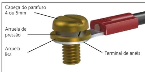
Nas unidades do invólucro Ex db eb, conexões para os terminais de energia e as deve ser feito usando o tipo AMP 160292 separadores para terminais de energia e de terra e AMP tipo 34148 separadores para os terminais de controle.
