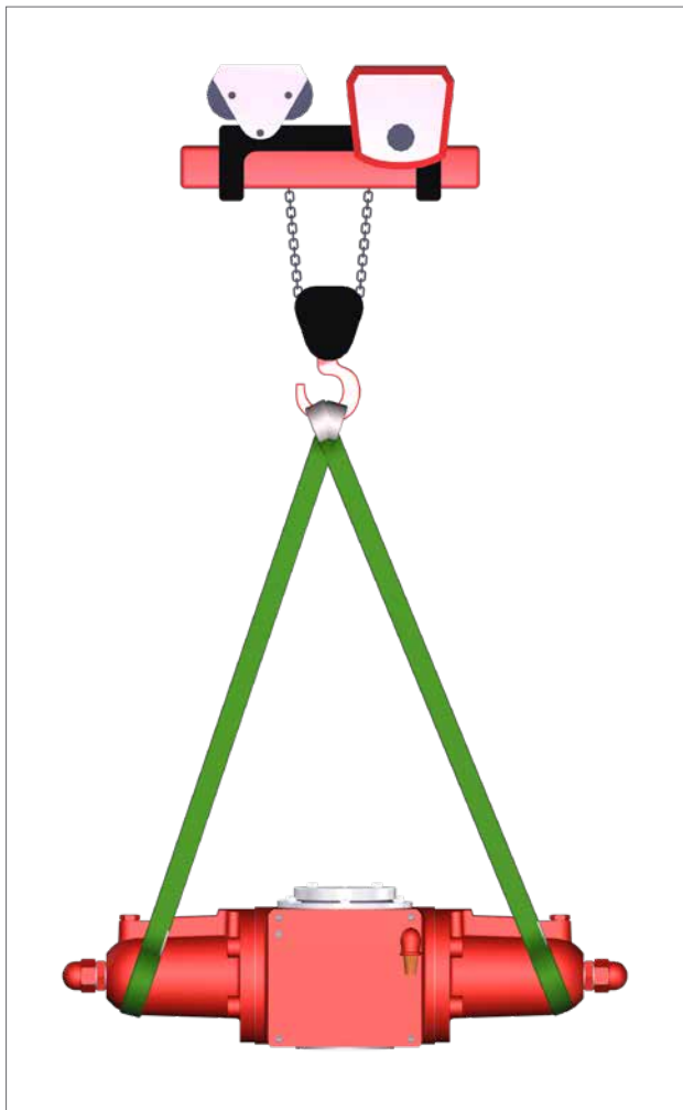
Fig 7.2 Levage de l'actionneur RH à double effet - tailles 015, 030, 060, 120, 240.
