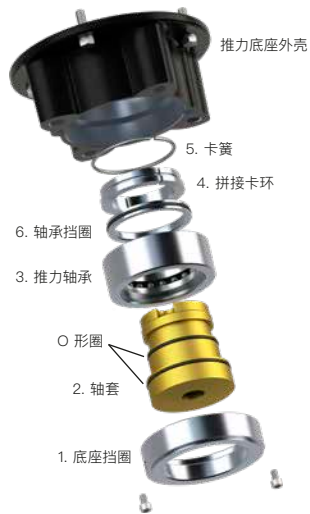
Fig. 5.1.3 F14 & F16 底座拆解图
