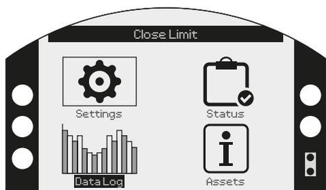
データロガーのデータは、現場にて、ドットマトリックス表示の画面上で確認することができ、圧力及び開度のグラフ、さらには統計的動作データも表示することができます。データロガーには、あらゆるデータが安全に保存されており、これらのデータをロトルクBluetooth設定器Proを用いてダウンロードし、Insight 2を起動したPCで閲覧することもできます。
