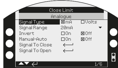
アナログ制御を選択すると、メニュー内で不感帯やヒステリシスを個別に調節することができますので、プロセスの状態に合わせて制御を最適化することができます。"要求開度に対する開度"を表すグラフは、ロトルクInsight 2(PC用ソフトウェア)を利用して、リア特性やイコールパーセント特性等、そのバルブの流量特性に合わせて、カスタマイズすることができます。
