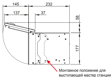
Вид сбоку с кронштейном в 19" стойке Дисплеи открыты
