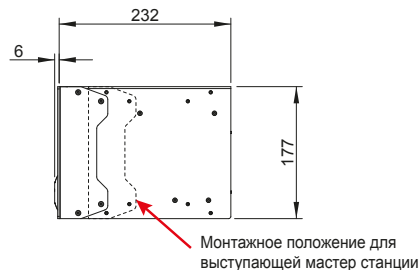
Вид сбоку с кронштейном в положении для настенного монтажа
