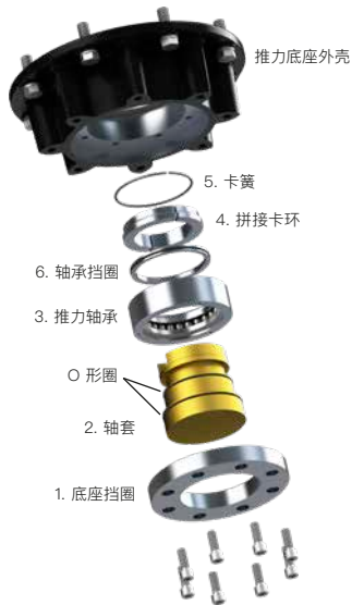
Fig. 5.1.4 F25 & F30 底座拆解图
