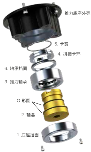
Fig. 5.1.3 F14 & F16 底座拆解图
