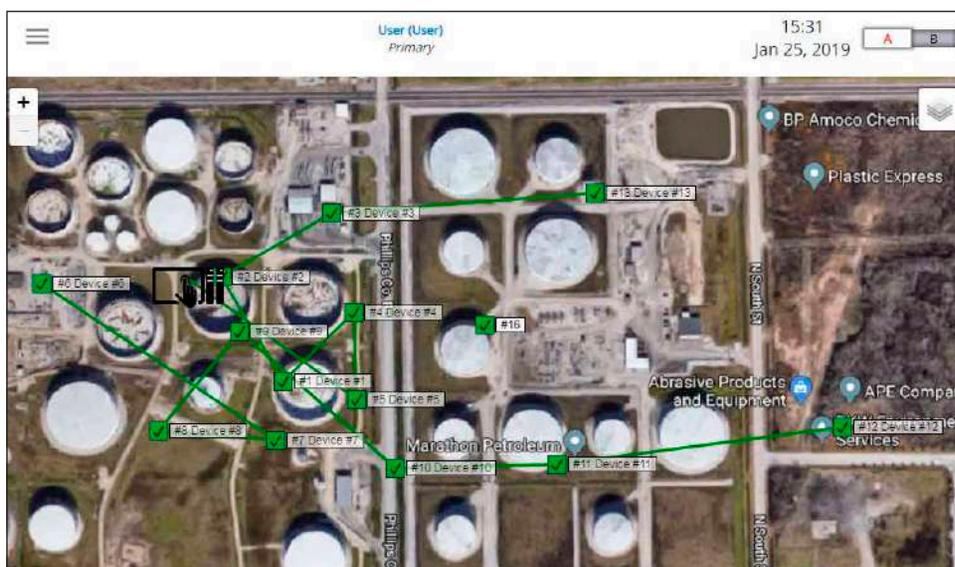
Страница Loop Map карта петли предназначена для отображения вида со спутника устройств в сети. Фоновое изображение сайта может быть загружено в общих настройках *Мастер станции*, чтобы устройства могли быть расположены в их примерных местах установки.
