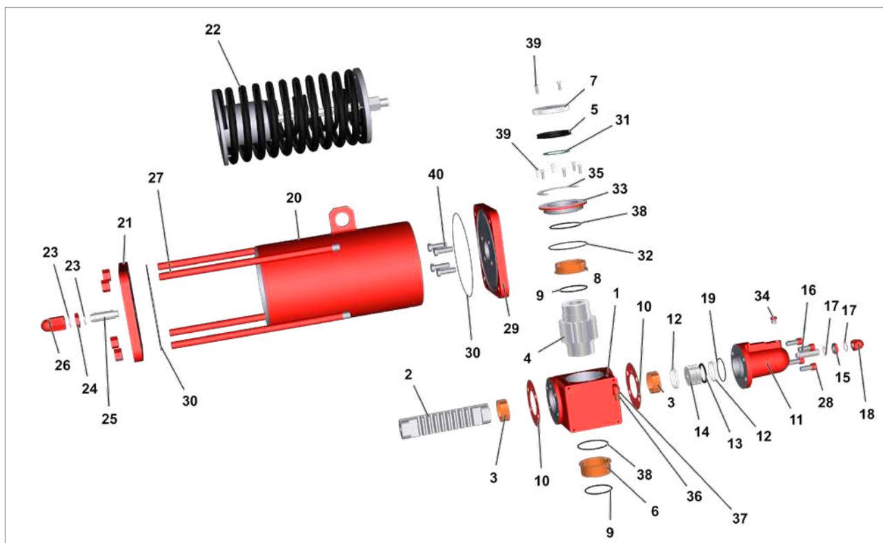
Fig 17.1 Actionneur à simple effet RH
