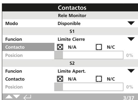
En la imagen superior se muestran como ejemplo las casillas de verificación del tipo de contacto de indicación S1.
