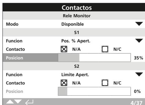
En la imagen superior se muestra como ejemplo el valor de la posición de indicación S1. La información de la función Pos. % Apert. del contacto S1 muestra la posición de la válvula en la cual el contacto cambiará de estado.
